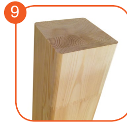
9 Drewno drzew iglastych o przekroju 90x90 mm, bezrdzeniowe, klejone warstwowo klejami poliuretanowymi całkowicie odpornymi na wodę. Drewno poddane trzyletowej procesowi impregnacji.
